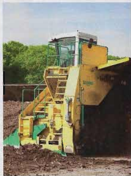
Puissant rotor. Munie d'un moteur Cummins QSX 6 cylindres, la machine exerce une pression sur le rotor de 180 à 200 bars. De quoi soulever des végétaux même chargés d'un fort taux d'humidité.
